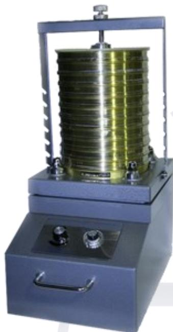
Аппарат для определения зернового состава песка: модель 01412 предназначен для определения гранулометрического состава, модуля мелкости и среднего размера зерна формовочных песков вибрационным методом и используется для работы в земельных лабораториях литейных цехов и центральных заводских лабораториях.
